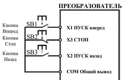
Рисунок 6-4. Трехпроводной режим 1 (пуск с нормально замкнутой кнопкой)
