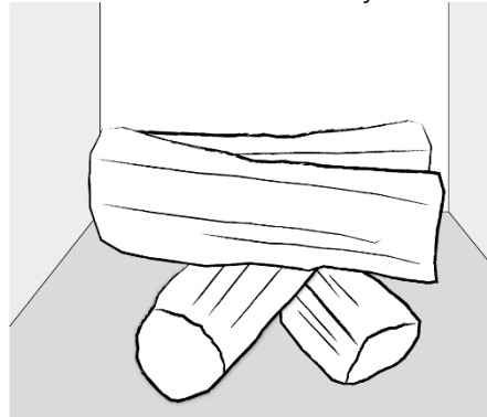
Figure 43 : Positionnement des bûches dans le Kalfire W80/52T
