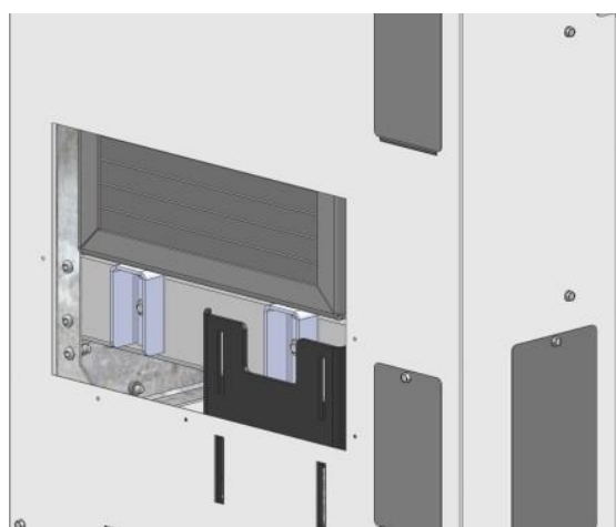
2. Retirer les 2 écrous M6 ainsi que les 2 écrous M8.
