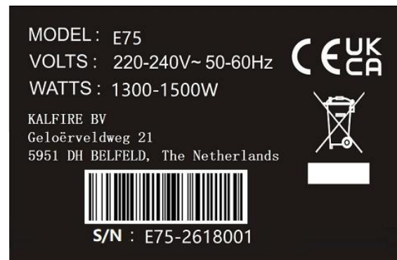
Abb. 16: Beispiel Typenschild mit eindeutiger Seriennummer (S/N)
