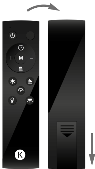
Fig. 15 : remplacement des piles
